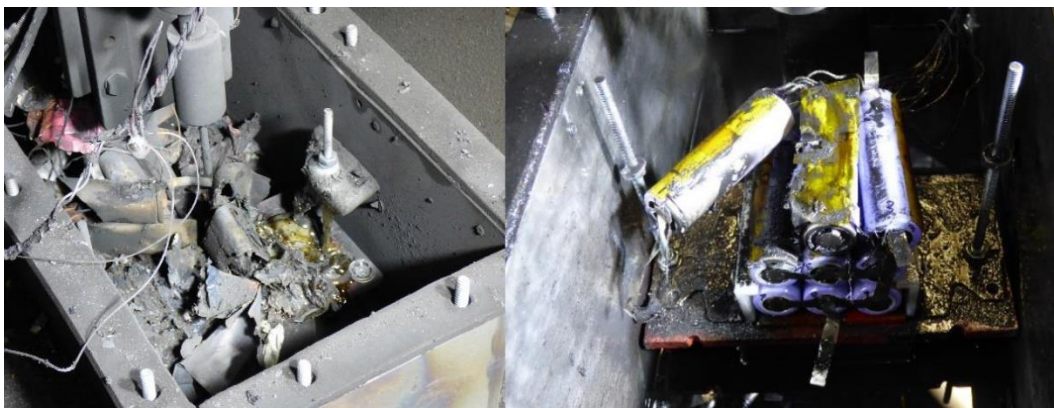
Abb. 4: Testergebnisse des Versuchs zum thermischen Durchgehen mit Luft und einem E-Fluid [4]
